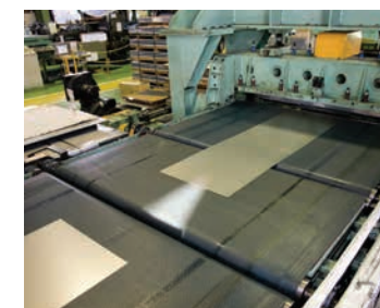
コイルは切断され、板状の製品となります。
