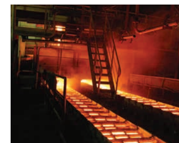
高炉から取出した溶鉄を再使用し易い形状の鉄原料とする為、鑄鉄機に溶鉄を流し型鉄を作っています。
