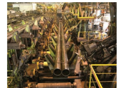
加工・精整された製品(パイプ)を自動結束機にて結束しています。
