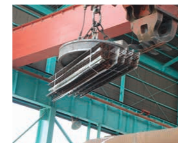
リフティング・マグネットによる荷卸しと選別を行っています。
