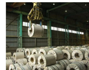
1個当たり10~20tあるコイルを 整然と丁寧に置いていきます。
