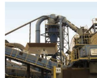
ギロチン設備、シュレッダー設備、プレス設備を利用し、スクラップの加工、選別、転炉挿入作業を一貫して行っています。
