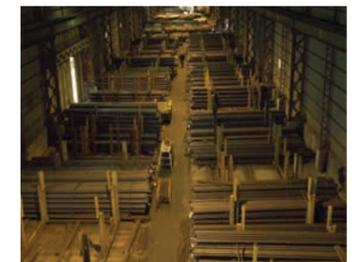
棒鋼専用倉庫では鋼鉄製保管枠を用いて
