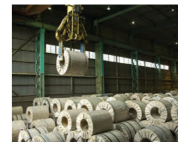
1個当たり10~20tあるコイルを 整然と丁寧に置いていきます。
