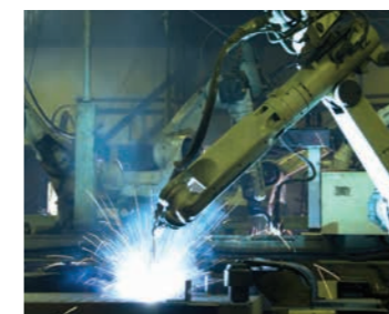
溶接は炭酸ガスアーク溶接ロボットにより行います。
