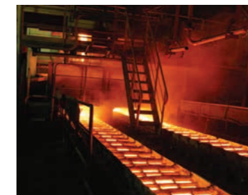
高炉から取出した溶銑を再使用し易い形状の鉄原料とする為、鑄鉄機に溶銑を流し型銑を作っています。
