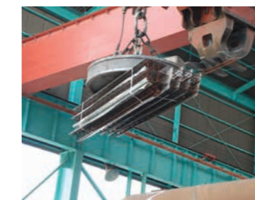
リフティング・マグネットによる荷卸しと選別を行っています。
