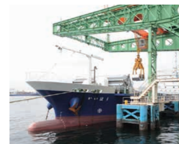
大型クレーンを使い、 本船から鉄鋼製品を吊り揚げます。
