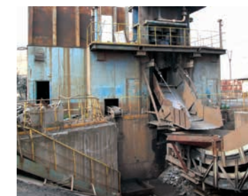
ギロチンシャーにより、インサイズ(炉前サイズ)に切断加工しています。
