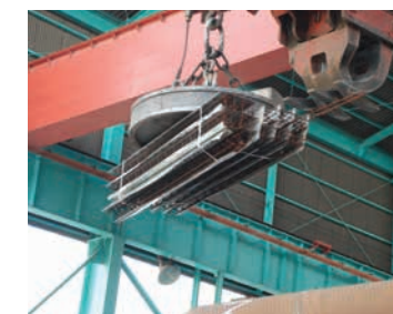
リフティング・マグネットによる荷卸しと選別を行っています。
