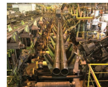
加工・精整された製品(パイプ)を自動結束機にて結束しています。
