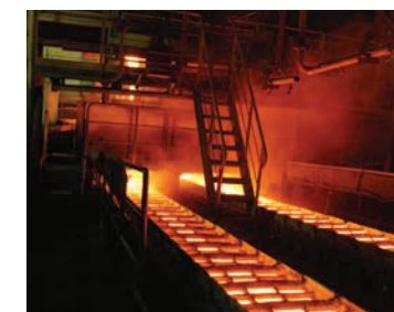
高炉から取出した溶鉄を再使用し易い形状の鉄原料とする為、鑄鉄機に溶鉄を流し型鉄を作っています。
