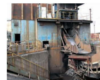
ギロチンシャーにより、インサイズ(炉前サイズ)に切断加工しています。
